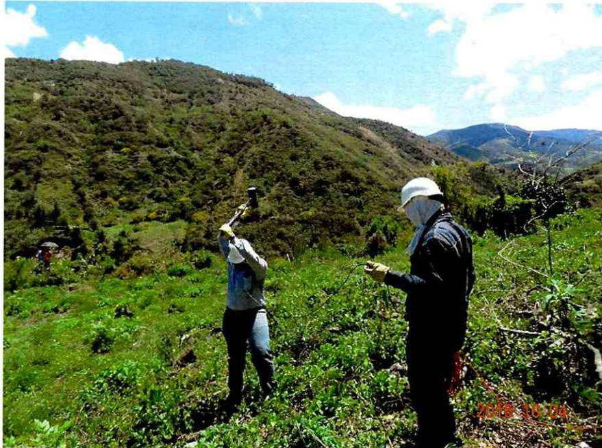
**FOTO 5.** Detalle de la generación de energía para la adquisición de datos en refracción sísmica y ondas superficiales.
