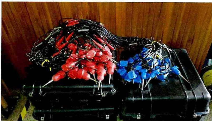
**Figura 13.** Geófonos utilizados para la ejecución de las líneas de Refracción Sísmica
